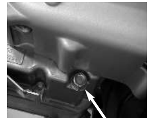
Tornillo de drenaje Par de apriete: 14.7N-m
