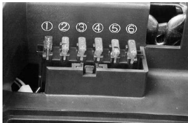
Rotura del filamento interno
