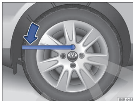
Fig. 138 Cambio de rueda: aflojar los tornillos de la rueda.
