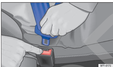
Fig. 44 Soltar la pestaña de encastre del cinturón de seguridad del cierre del cinturón.
