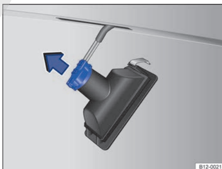
Fig. 152 Luz de la placa de licencia: retirar el portalámparas.
