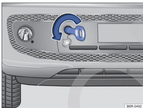
Fig. 155 En el parachoques delantero a la derecha: enroscar la argolla de remolque.
