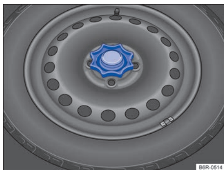
Fig. 118 En el maletero: manivela para fijación de la rueda de emergencia.
