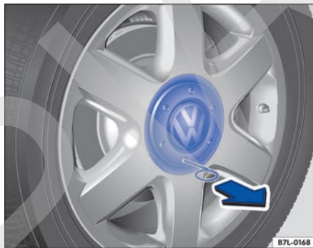
Fig. 135 Retirar el cubrerrueda de la rueda de aleación ligera.
