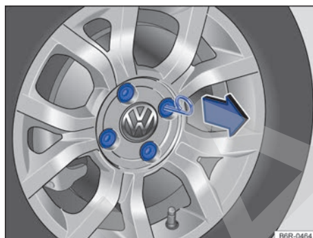
Fig. 137 Retirar los capuchones de los tornillos de rueda.
