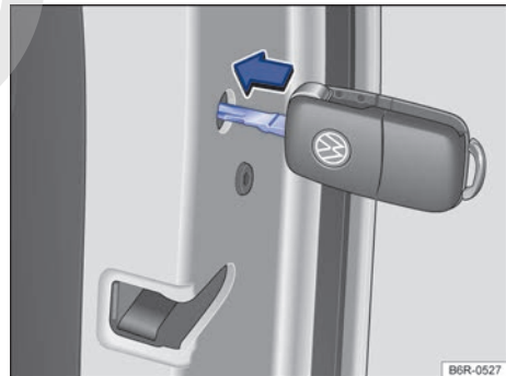
Fig. 131 Cierre de emergencia del vehículo con la llave del vehículo.
