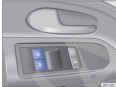
Fig. 30 En la puerta del conductor: teclas de los levanta vidrios eléctricos delanteros.
