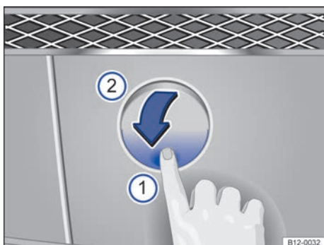
Fig. 154 En el parachoques delantero a la derecha: aflojar y desmontar la cubierta.
