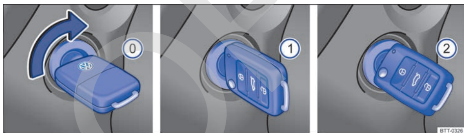
Fig. 83 Al lado del volante de la dirección, a la derecha: posiciones de la llave del vehículo en la cerradura de encendido.
