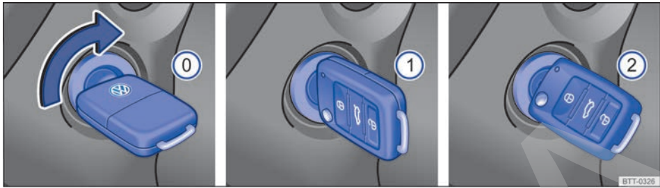
Fig. 97 Al lado del volante, a la derecha: posiciones de la llave del vehículo en el cilindro de encendido.
