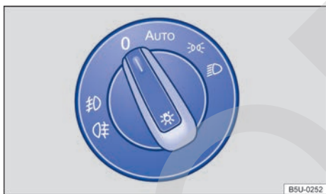
Fig. 66 En el panel: interruptor de las luces.
