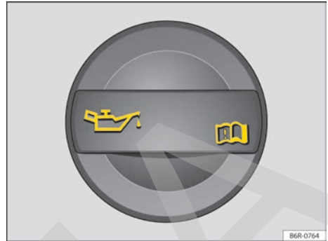
Fig. 127 En el compartimento del motor: tapa de la abertura de carga del aceite del motor.
