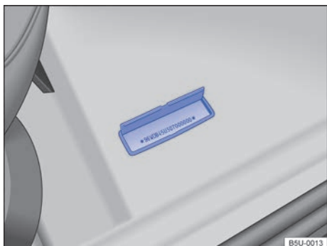
Fig. 19 Delante del asiento del acompañante delantero: número de identificación del vehículo (número del chasis) en el piso, delante del asiento del acompañante delantero.
