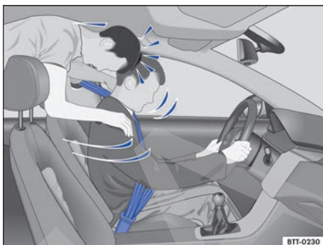
Fig. 49 Un pasajero sin cinturón de seguridad en el asiento trasero es arrojado hacia adelante sobre el conductor con cinturón.
