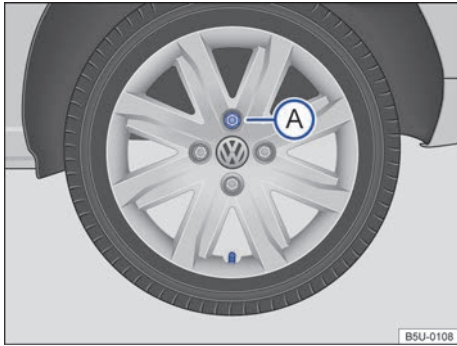
Fig. 161 Cambio de rueda: secuencia de remoción de los tornillos de la rueda.
