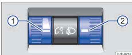
**Fig. 72** Junto al volante: regulador de la iluminación de los instrumentos y los mandos ① y regulador del alcance de las luces ②.
