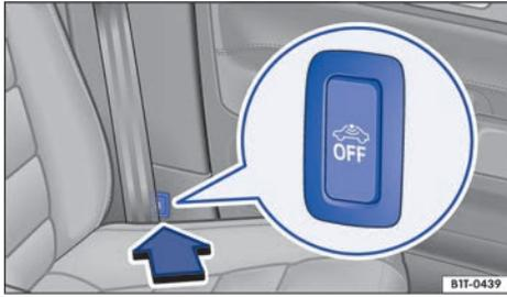
**Fig. 22** Junto al asiento del conductor: tecla para desconectar la vigilancia del habitáculo y el sistema antirremolcado.
