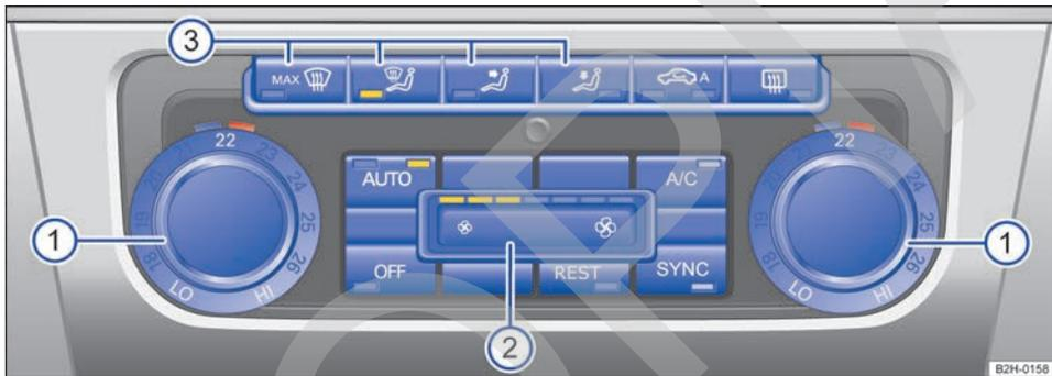
Fig. 123 En el tablero de instrumentos: mandos del Climatronic.
