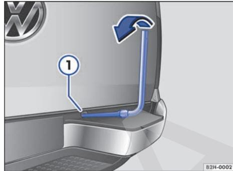
Fig. 155 Bajar la rueda de auxilio mediante el malacate.
