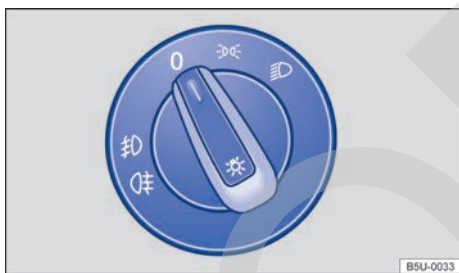
Fig. 66 En el panel: interruptor de las luces.
