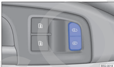
Fig. 29 En la puerta del conductor: teclas del bloqueo central.
