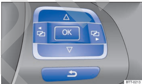
Fig. 17 Lado derecho del volante multifunción: teclas de comando.
