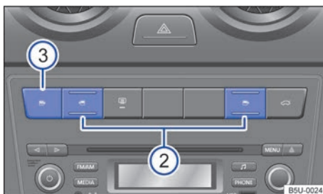
Fig. 36 En la consola central: teclas de los vidrios eléctricos traseros.
