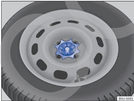
Fig. 139 En el compartimento de equipaje: palanca para fijar la rueda de emergencia.
