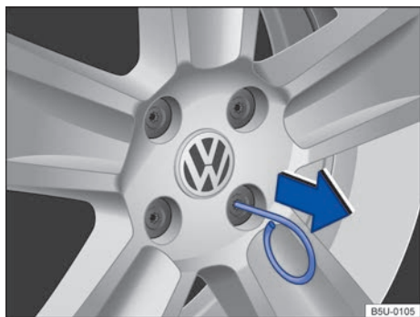
Fig. 157 Remover las capas de cobertura de los tornillos de la rueda.
