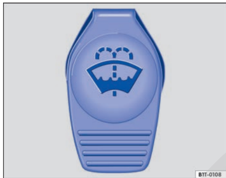
Fig. 73 En el compartimento del motor: tapa del tanque de agua de los lavaparabrisas.
