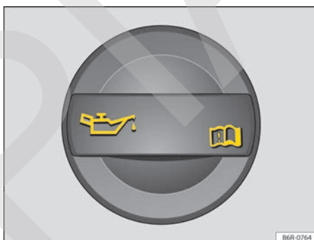
Fig. 127 En el compartimento del motor: tapa de la abertura de carga del aceite del motor.
