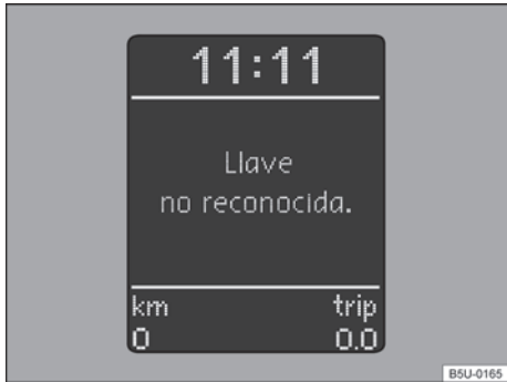
Fig. 98 En el panel de instrumentos: display con indicación del inmovilizador activado.
