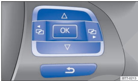
Fig. 14 Lado derecho del volante multifunción: teclas de comando de los menús del panel de instrumentos.
