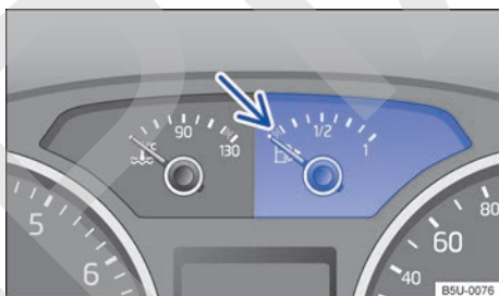
Fig. 122 En el panel de instrumentos: indicador de la reserva de combustible (variante 2).
