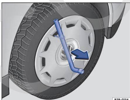
Fig. 168 Extraer el tapacubos integral que va encajado.
