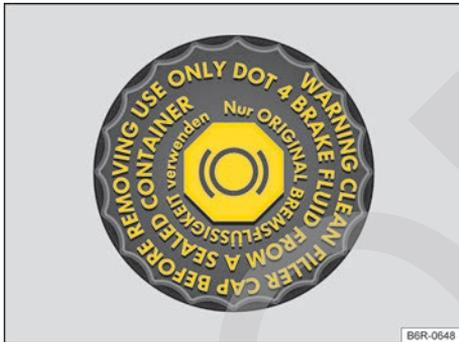
**Fig. 125** En el vano motor: tapa del depósito del líquido de frenos (variante 2).
