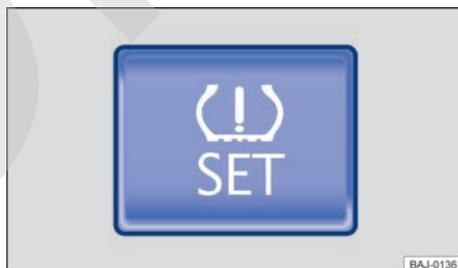
Fig. 143 En la guantera: tecla del sistema de control de los neumáticos.
