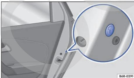
**Fig. 159** En el frontal de la puerta trasera derecha: bloqueo de emergencia cubierto por una junta de goma.
