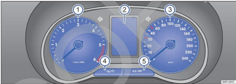
Fig. 12 Cuadro de instrumentos en el tablero de instrumentos: variante 1.
