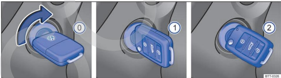
Fig. 112 Posiciones de la llave del vehículo en la cerradura de encendido.
