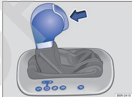
**Fig. 118** Vehículo con el volante a la derecha: palanca selectora del cambio automático con tecla de bloqueo (flecha).
