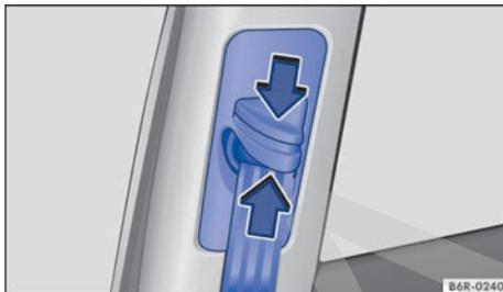
**Fig. 55** Junto a los asientos delanteros: regulador de la altura del cinturón.
