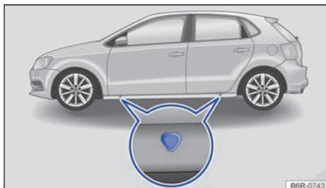
**Fig. 173** Puntos de apoyo para el gato (el lado derecho del vehículo es simétrico).
