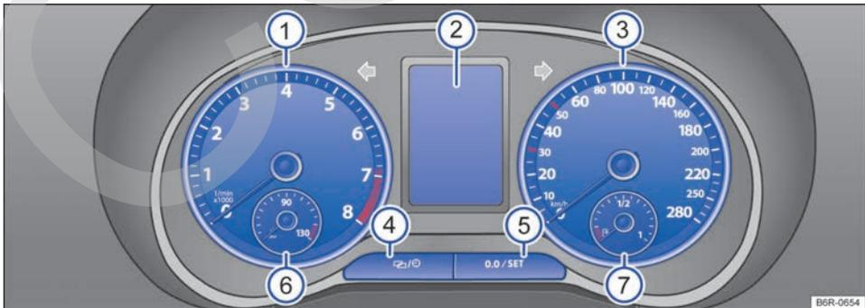
Fig. 13 Cuadro de instrumentos en el tablero de instrumentos: variante 2.
