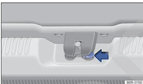
**Fig. 162** Vehículo sedán, en el maletero: desbloqueo de emergencia del portón del maletero.
