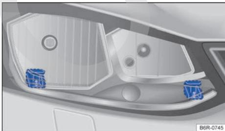
Fig. 184 Guías para el montaje del faro derecho.
