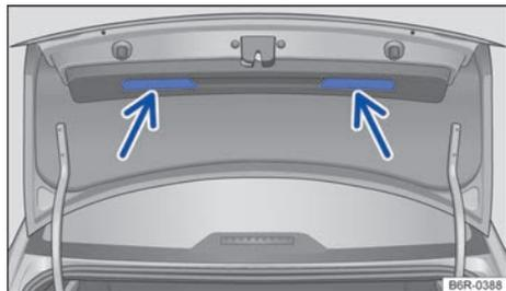
**Fig. 29** Vehículo sedán: cavidades para tirar hacia abajo del portón del maletero abierto.
