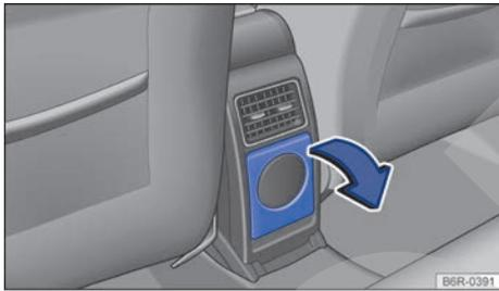
Fig. 107 En la parte trasera de la consola central: portabebidas (variante 1).
