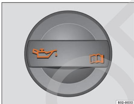
Fig. 139 En el vano motor: tapa de la boca de llenado de aceite.
