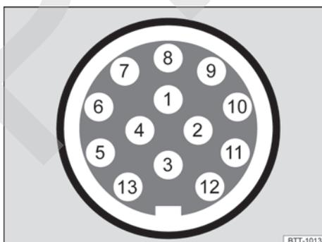
**Fig. 93** Representación esquemática: asignación de los pines de la toma de corriente para remolque.
