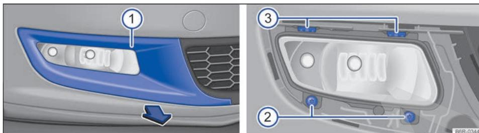
Fig. 190 En el lado derecho del paragolpes delantero: desmontaje de la cubierta y del faro (variante 1).
