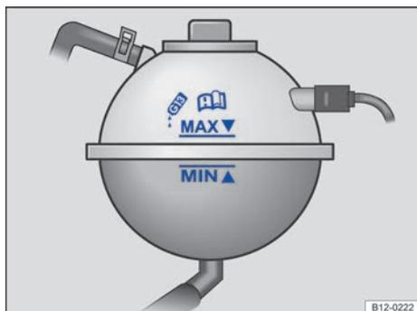
**Fig. 140** En el vano motor: marcas en el depósito de expansión del líquido refrigerante del motor. ▶
