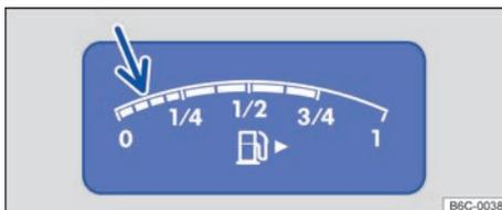
Fig. 133 En el cuadro de instrumentos: indicador del nivel de gasolina o gasóleo.
