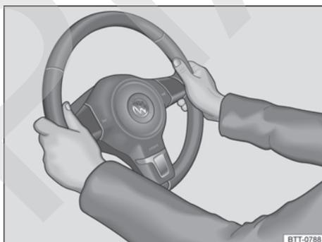
**Fig. 40** En el volante: posición equivalente a las 9 y las 3 horas.
