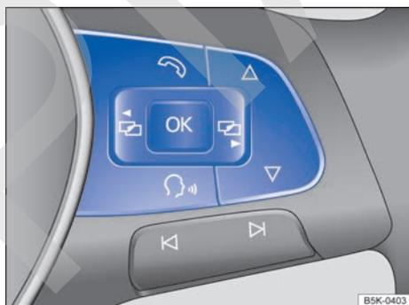
**Fig. 16** Vehículos con volante multifunción: teclas para utilizar los menús del cuadro de instrumentos.
