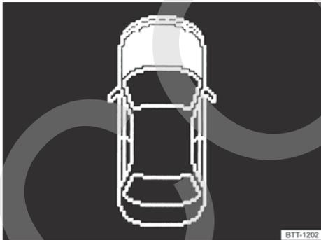
**Fig. 135** Representación esquemática en la pantalla del cuadro de instrumentos: capó del motor abierto o no cerrado correctamente.
