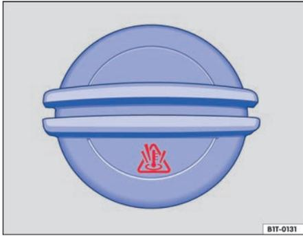
**Fig. 141** En el vano motor: tapa del depósito de expansión del líquido refrigerante del motor.
