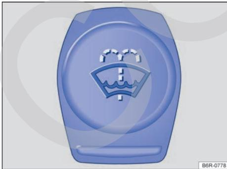
**Fig. 79** En el vano motor: tapa del depósito del lavacristales.
