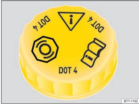
**Fig. 124** En el vano motor: tapa del depósito del líquido de frenos (variante 1).
