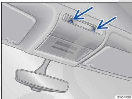
**Fig. 23** En la consola del techo: sensores de la vigilancia del habitáculo (flechas).
