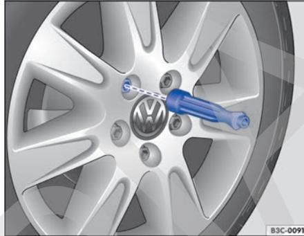
**Fig. 177** Cambio de rueda: desenroscar los tornillos de rueda con el mango del destornillador.
