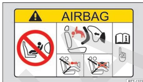
Fig. 63 Representación esquemática: etiqueta adhesiva relativa al airbag en el parasol.
