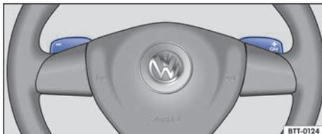
**Fig. 120** Volante con dos levas de cambio para el Tiptronic.
