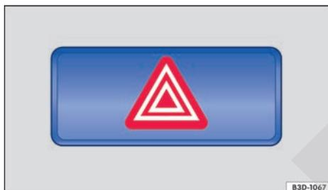
**Fig. 154** En la parte superior de la consola central: pulsador para conectar y desconectar los intermitentes de emergencia.
