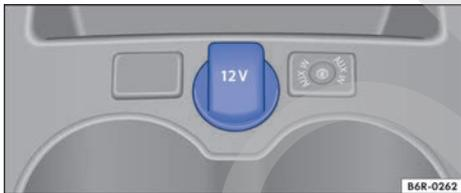
**Fig. 111** En la parte delantera de la consola central: toma de corriente de 12 voltios.
