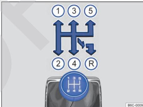
**Fig. 116** Esquema de un cambio manual de 5 marchas (variante 2).
