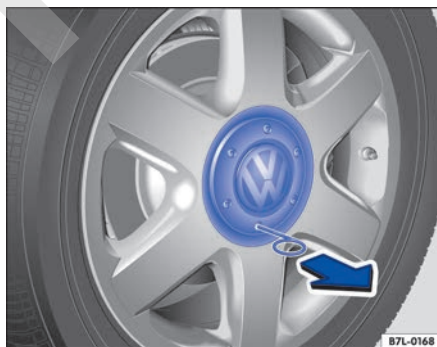
Fig. 172 Desmontar el tapacubos central tirando de él.
