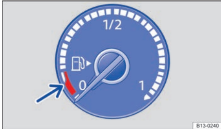
Fig. 14 En el cuadro de instrumentos: indicador del nivel de gasolina o gasóleo.
