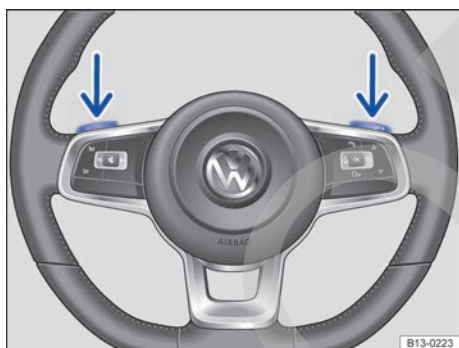
Fig. 97 Volante con levas de cambio para el Tiptronic.
