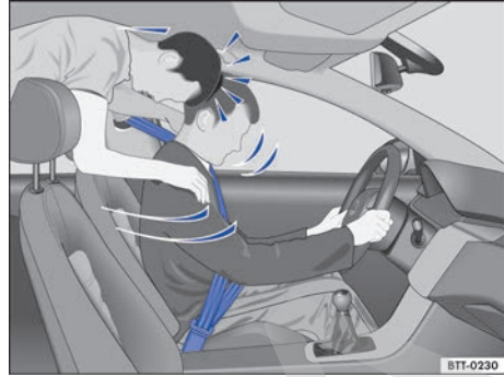
Fig. 23 El ocupante del asiento trasero sin el cinturón de seguridad colocado sale lanzado hacia adelante topando contra el conductor, que sí lo lleva colocado.
