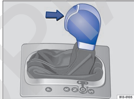
Fig. 95 Vehículo con el volante a la izquierda: palanca selectora del cambio automático con tecla de bloqueo (flecha). En los vehículos con el volante a la derecha, la disposición es simétrica.
