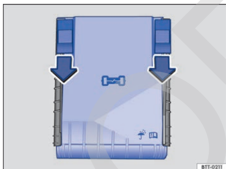
Fig. 146 En el vano motor: cubierta de la caja de fusibles.
