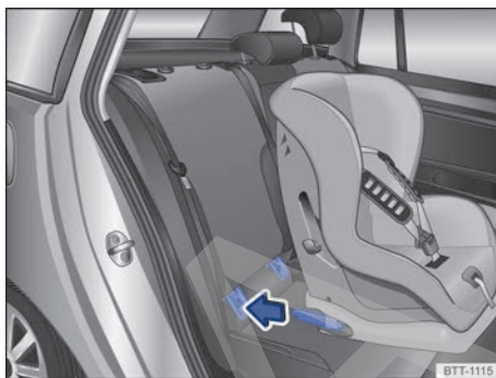
Fig. 40 Representación esquemática: montaje de un asiento para niños ISOFIX con conectores.
