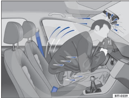
Fig. 22 El conductor sin el cinturón de seguridad colocado sale lanzado hacia adelante.
