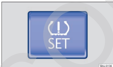
Fig. 165 En la guantera: tecla del sistema de control de los neumáticos.
