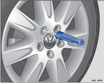
Fig. 180 Cambio de rueda: desenroscar los tornillos de rueda con el mango del destornillador.
