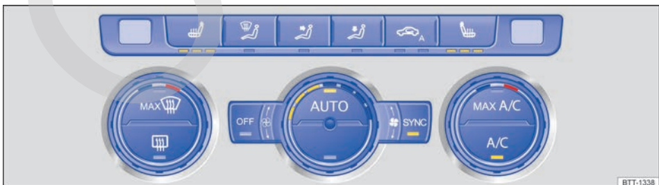
Fig. 85 En la parte superior de la consola central: mandos del Climatronic. ▶
