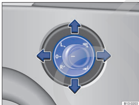
Fig. 82 En la puerta del conductor: mando giratorio de los retrovisores exteriores.
