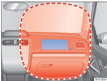
Fig. 31 Ubicación y zona de despliegue del airbag frontal del acompañante.
