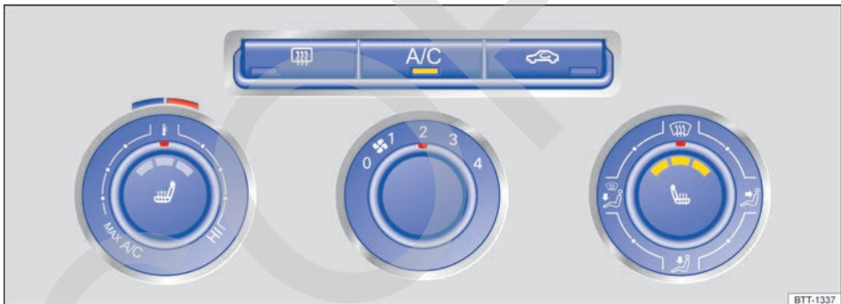
Fig. 84 En la parte superior de la consola central: mandos del climatizador manual.
