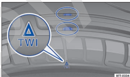
Fig. 169 Perfil del neumático: indicadores de desgaste.
