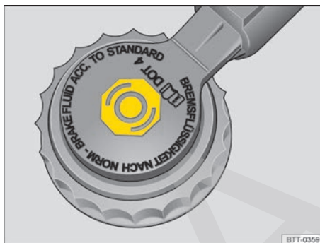
Fig. 162 En el vano motor: tapa del depósito del líquido de frenos.
