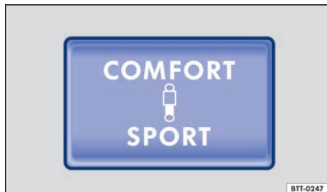
Fig. 100 En la parte inferior de la consola central: tecla para ajustar la suspensión adaptativa.
