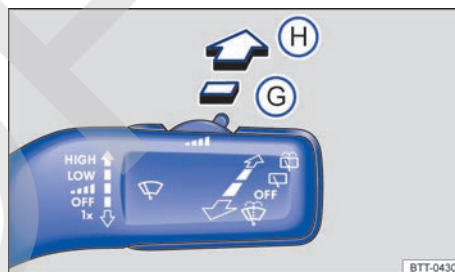
Fig. 78 En el lado derecho de la columna de dirección: manejo del limpialuneta.
