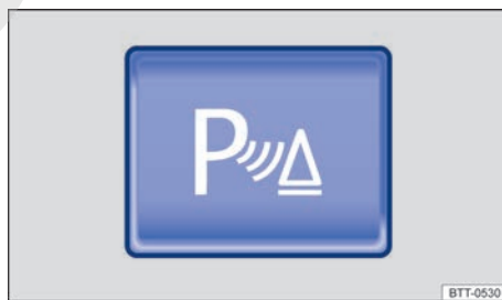
< Fig. 107 En la consola central: tecla para conectar y desconectar la ayuda de aparcamiento (en función del equipamiento).
