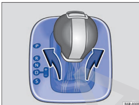
Fig. 98 Desmontar la cubierta de la corredera de la palanca selectora.
