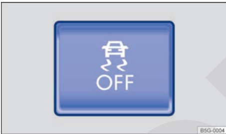
Fig. 112 En la consola central: tecla para desconectar y conectar manualmente el ASR.
