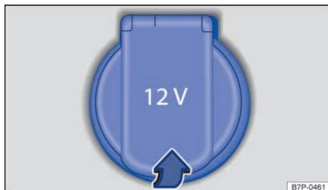
**Fig. 193** En el portaobjetos situado debajo del reposabrazos central delantero: apertura de la toma de corriente de 12 voltios.
