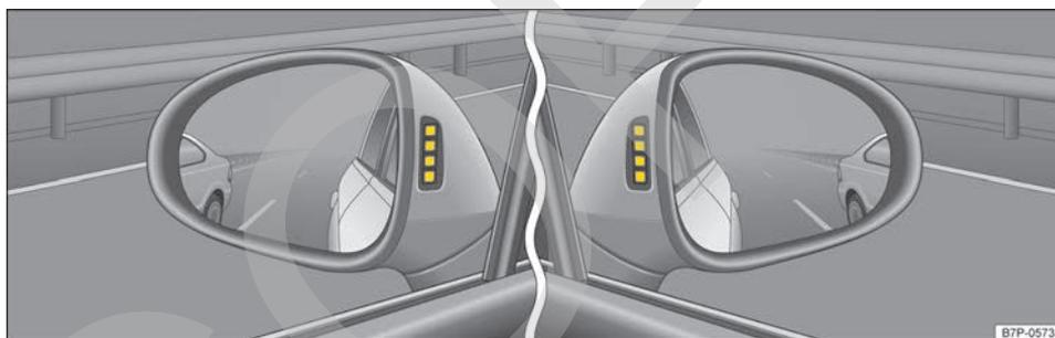
**Fig. 165** En las carcasas de los retrovisores exteriores: indicadores ópticos del asistente de cambio de carril (Side Assist).
