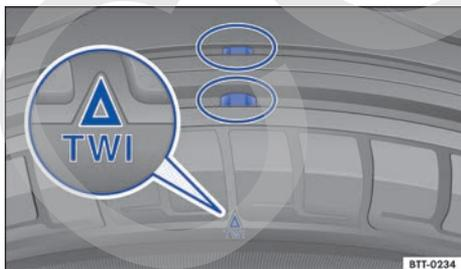
Fig. 259 Perfil del neumático: indicadores de desgaste.
