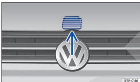
**Fig. 242** Encima de la parrilla del radiador: palanca de apertura del capó del motor.
