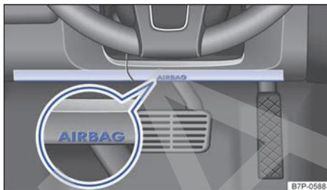
**Fig. 54** En el lado del conductor: ubicación del airbag para las rodillas.
