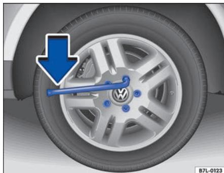
Fig. 265 Cambio de rueda: aflojar los tornillos de rueda.
