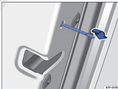
**Fig. 75** En el frontal de la puerta trasera derecha: bloqueo de emergencia del vehículo con la llave de emergencia.
