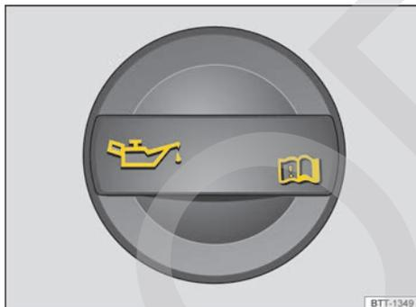
Fig. 247 En el vano motor: tapa de la boca de llenado de aceite del motor (representación esquemática).
