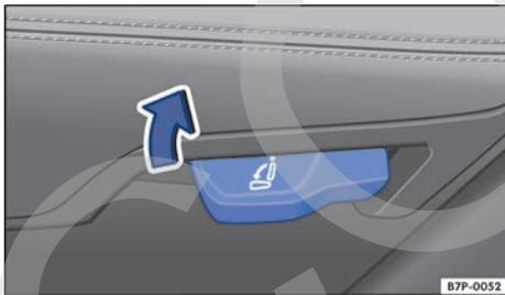
**Fig. 96** Parte inferior del asiento trasero: palanca para desbloquear el respaldo izquierdo del asiento. El lado derecho es simétrico.
