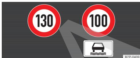
**Fig. 18** En la pantalla del cuadro de instrumentos: ejemplos de limitaciones de velocidad reconocidas con sus respectivos paneles complementarios.
