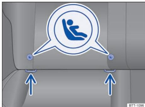
**Fig. 59** En el asiento del vehículo: señalización de los puntos de anclaje ISOFIX para los asientos para niños.
