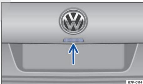
Fig. 78 En el portón del maletero: pulsador para abrir el portón.
