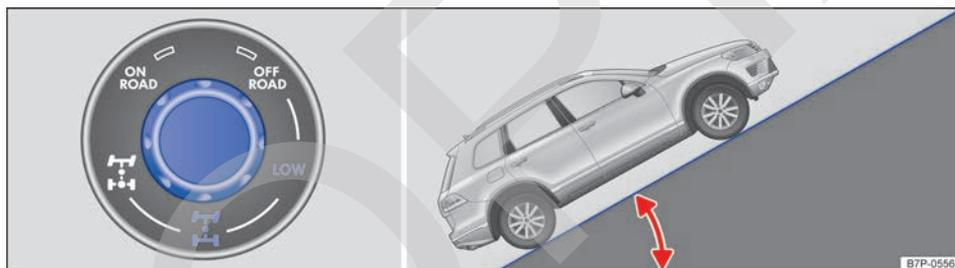
**Fig. 145** Etapa reductora LOW conectada con el diferencial central bloqueado.
