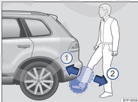
**Fig. 72** Sistema de cierre y arranque sin llave Keyless Access: abrir el portón del maletero con apertura controlada por sensor (Easy Open).
