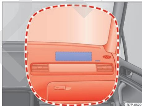
**Fig. 49** Ubicación y zona de despliegue del airbag frontal del acompañante.
