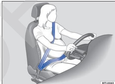
Fig. 45 Colocación correcta de la banda del cinturón en el caso de mujeres embarazadas.
