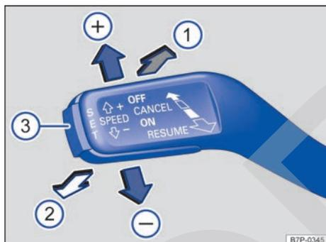
**Fig. 153** Lado izquierdo de la columna de dirección: palanca de mando del GRA.
