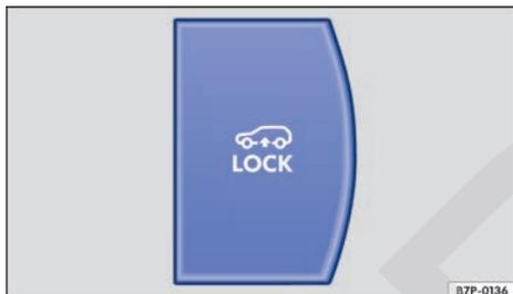
**Fig. 140** En la parte inferior de la consola central: tecla Lock de la limitación de velocidad.
