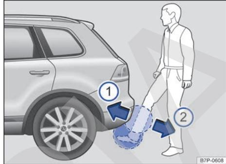
Fig. 80 Portón del maletero con apertura controlada por sensor (Easy Open).
