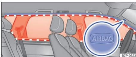
**Fig. 53** En el lado izquierdo del vehículo: ubicación y zona de despliegue del airbag para la cabeza.
