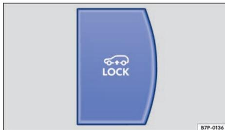
Fig. 264 En la parte inferior de la consola central: tecla Lock.
