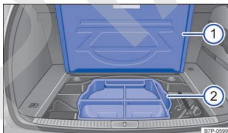
Fig. 218 En el maletero: depósito de AdBlue debajo del organizador de plástico.
