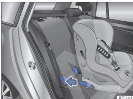
**Fig. 60** Representación esquemática: montaje de un asiento para niños ISOFIX con conectores.
