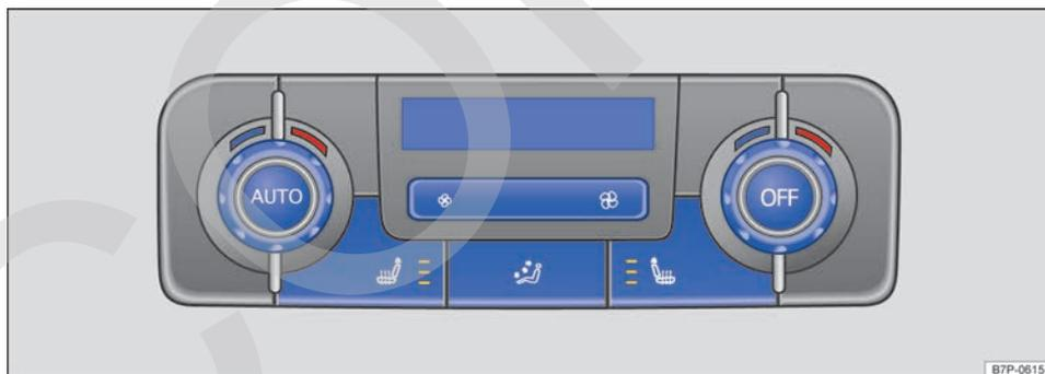
Fig. 123 En la parte trasera de la consola central: mandos del Climatronic.
