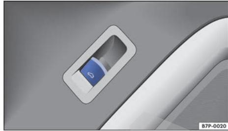
**Fig. 70** En la puerta del conductor: desbloqueo del portón del maletero.
