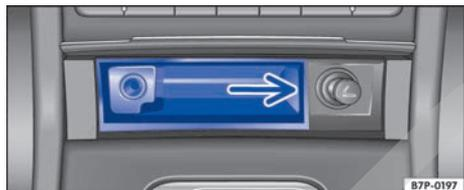
Fig. 189 En la parte delantera de la consola central: extraer el cenicero.
