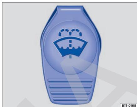
**Fig. 245** En el vano motor: tapa del depósito del lavacristales.
