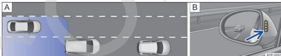
Fig. 166 **A** Situación en un adelantamiento con tráfico en la parte trasera. **B** En el retrovisor exterior izquierdo: indicador óptico.
