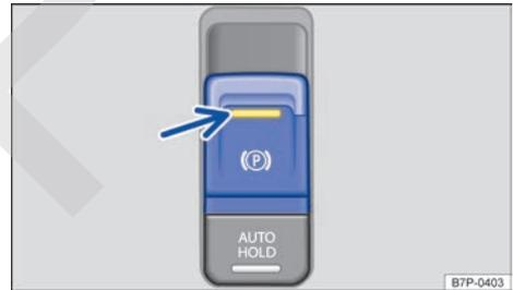
**Fig. 168** En la consola central: tecla del freno de estacionamiento electrónico.
