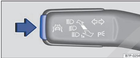
**Fig. 22** En la palanca de los intermitentes y de la luz de carretera: tecla de los sistemas de asistencia al conductor.
