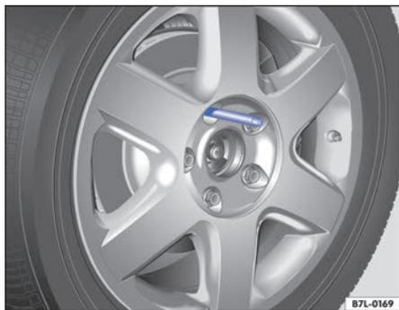
**Fig. 269** Cambio de rueda: pasador de montaje en el orificio superior.
