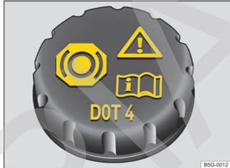
Fig. 250 En el vano motor: tapa del depósito del líquido de frenos.
