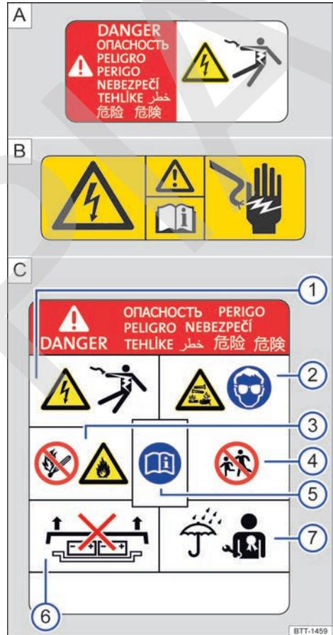
Fig. 252 Letreros de advertencia (representaciones esquemáticas): **A** Componentes de alto voltaje. **B** Letrero de advertencia general de alto voltaje. **C** Letrero de advertencia de la batería de alto voltaje.
