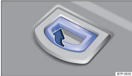
**Fig. 206** En el maletero: argolla de amarre desplazable.
