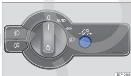
**Fig. 110** Junto al volante: regulador de la iluminación de los instrumentos y los mandos.
