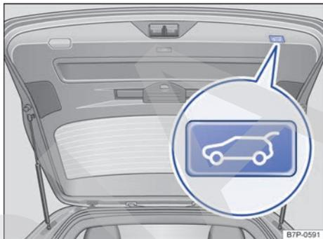
**Fig. 79** En el portón del maletero abierto: tecla para cerrar el portón.
