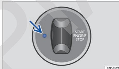
**Fig. 67** Cerradura de encendido: desbloqueo de emergencia de la llave.
