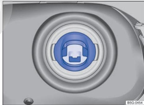
**Fig. 217** En la boca de llenado del depósito de combustible: protección contra repostaje equivocado.
