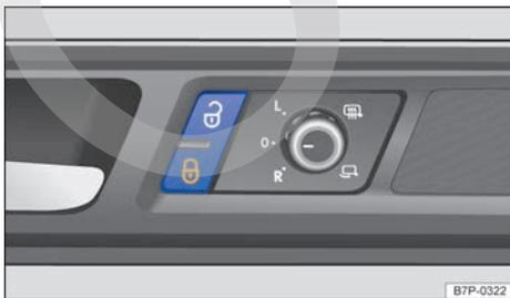
**Fig. 69** En la puerta del conductor: tecla del cierre centralizado.
