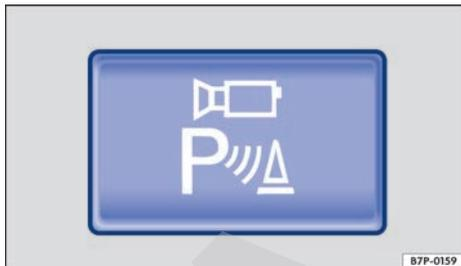
Fig. 178 En la parte superior de la consola central: tecla para conectar manualmente el sistema de visión periférica.
