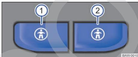
**Fig. 76** En la puerta del conductor: teclas del seguro para niños eléctrico.
