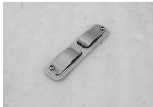
**VÁLVULA DE LENGÜETA DEL RESPIRADERO DEL CÁRTER****EXTRACCIÓN**
