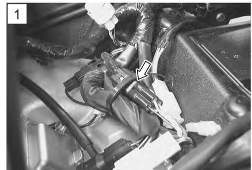
4) Desconecte el acoplador del sensor HO2 y mida la resistencia entre los terminales.
