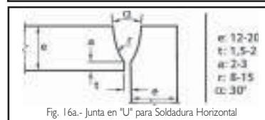
Fig. 16a.- Junta en "U" para Soldadura Horizontal
