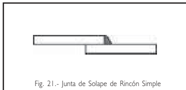
Fig. 21.- Junta de Solape de Rincón Simple
