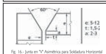
Fig. 16.- Junta en "V" Asimétrica para Soldadura Horizontal
